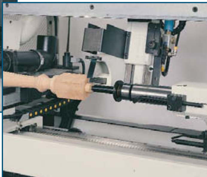
Carrello tuffante a comando idraulico (opzionale) per lavori di finitura o esecuzione di spine cilindriche.
