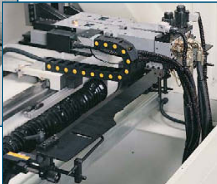
Particolare delle 2 sgorbie a "V" montate su copiatori idraulici e della terza sgorbia per cilindrare.
