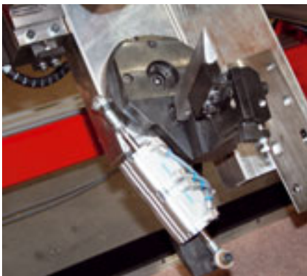
Programmgesteuerter Schwenkstahl Program-controlled swivel head Outil commande par programmé
