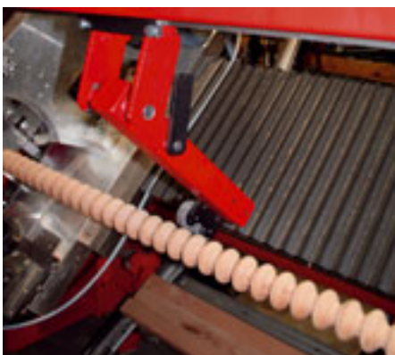
Programmgesteuerte Stützlunette Program-controlled supporting back stay Lunette de tournage commandée par programme
