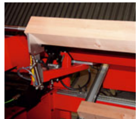
Magazin für Vierkantholz 30x30 bis 100x100 mm, Einlegelänge von 200 – 1600 mm Magazine for squared timber: 30x30 to 100x100 mm, Insert length: 200 – 1600 mm Magasin pour bois équarri 30x30 à 100x100 mm Longueur d'insertion de 200 à 1600 mm
